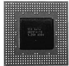
Figure 4. Cavity-down package.
